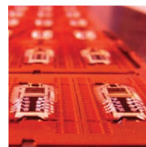
Die and Epoxy AOI
